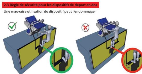
**Ne jamais exercer de pression sur le repose-pied lorsqu'il forme un angle de 90° avec la plaque de touche.**
